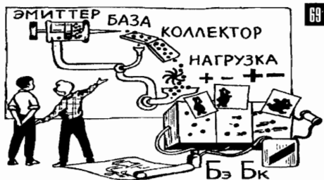
69. Заряды из эмиттера легко попадают в базу (открытый переход) и, просочившись через нее (диффузия), сильно ускоряются коллектором (Т-141).
