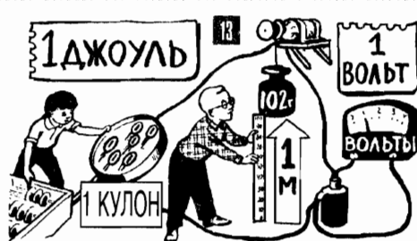
13. Чем больше ЭДС (напряжение), тем лучше поработает каждый заряд, пройдя по цепи. Единица ЭДС — вольт: каждый кулон выполняет работу в один джоуль (Т-30).
