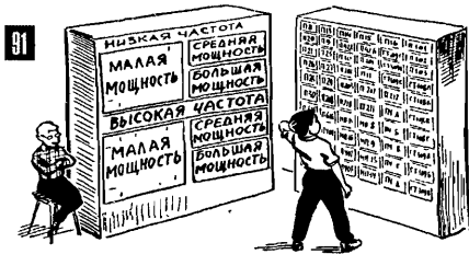
91. Огромное многообразие транзисторов можно разделить на несколько основных групп (Т-151).
