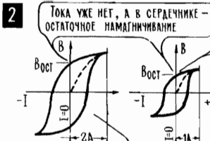
МЕНЯЕМ ТОК, И МЕНЯЕТСЯ МАГНИТНАЯ ИНДУКЦИЯ В (P-35)
