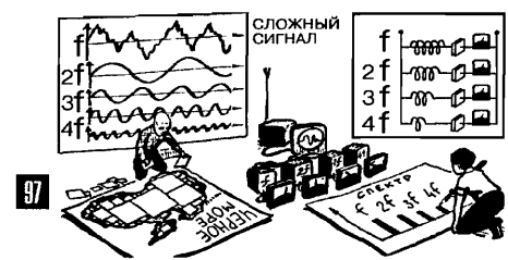
97. Спектр сигнала: набор синусоидальных составляющих, которые, сложившись, точно воспроизведут этот сигнал (Т- ).
