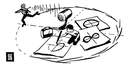
96. Диаграмма направленности микрофона показывает, как он воспринимает звук с разных направлений (Т-109, Т-311).
