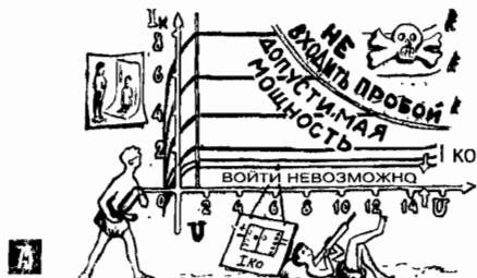
74, 75. Выходная характеристика транзистора: зависимость коллекторного тока I_k от коллекторного напряжения U_k при разных напряжениях на базе U_b (Т-145).
