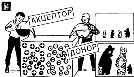
54, 55. Полупроводниковый диод: две зоны с разным типом примесной проводимости — зона p (свободные «дыр-
