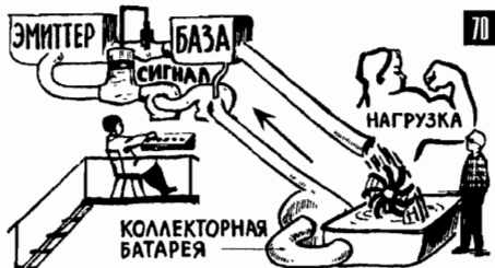
70. Слабый сигнал на эмиттерном переходе легко меняет количество зарядов, попавших в базу, коллекторная батарея, ускорив их, создает мощную копию слабого сигнала (Т-141).
